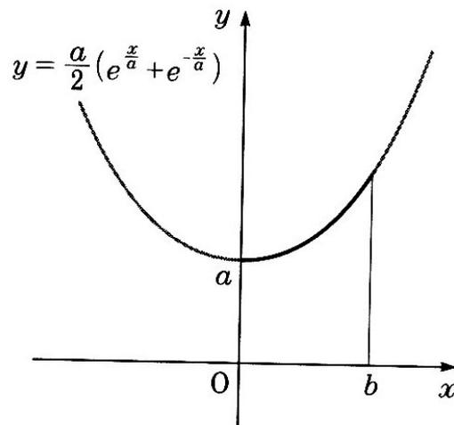
**注意 1** この例題の曲線は懸垂線と呼ばれ、一様な線密度の送電線・架線などが重力の作用で自然にたれてできる形である。
